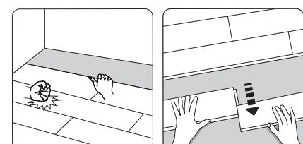
Efter rækken er løsnet, kan brædderne adskilles ved at skyde (ikke løfte) dem sidelæns på den korte side.
